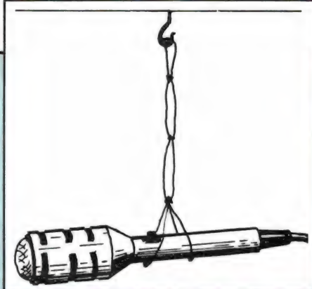
Fig. 2. Een even goedkope als doeltreffende verende microfoonopstelling: gewoon opgehangen aan een rijtje aan elkaar geknoopte elastiekjes. Het lijkt knutselwerk, maar het leidt tot professionele resultaten!
